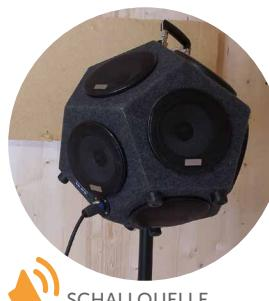
Die Messung erfolgt durch Aktivierung einer bestimmten Geräuschquelle im Senderraum und Messung der Schalldruckpegel in beiden Räumen (Sender und Empfänger). Die Schalldämmung ergibt sich aus der Differenz der beiden gemessenen Pegel. Je höher also der Wert  $R_w$ , desto besser die Schalldämmung des Aufbaus.
